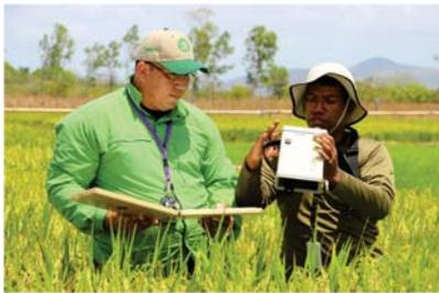
Fig. 1. Adquisición de firmas espectrales de un cultivo con el uso del espectrorradiómetro.
