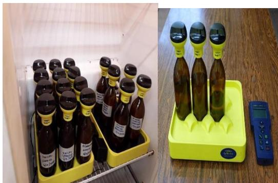
**Figura 3. a) Sistema de medición Oxitop. b) Interface OC110.**
