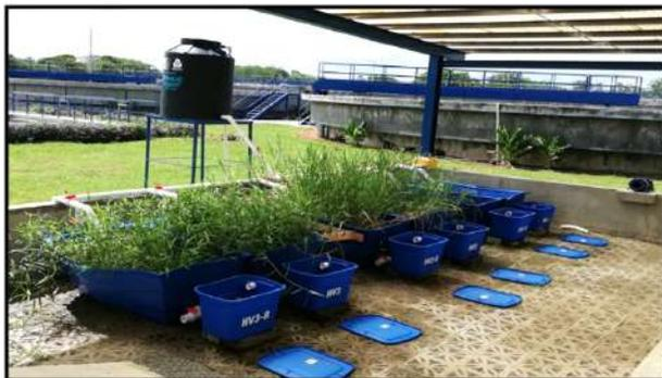
**Fig. 1: Sistema piloto de humedales artificiales. Fotografía: Liz Miller Gil.**
