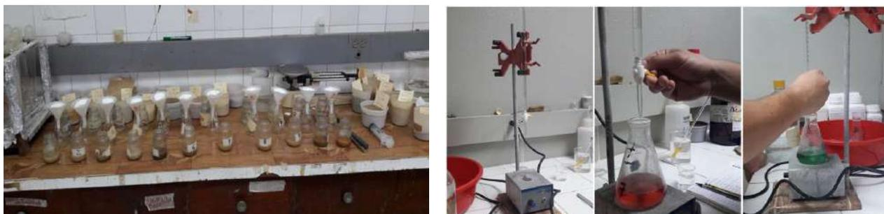
Fig. 1. Determinación de capacidad de intercambio catiónico.
