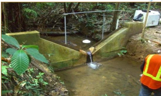
Vertedor triangular de pared delgada a la salida de la microcuenca de Cerro Pelado.
