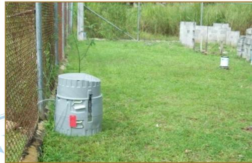
Instalación del muestreador en la toma de agua del río Pacora.
