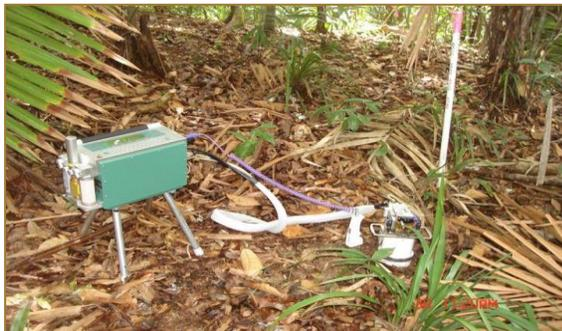
Equipo de medición de intercambio de carbono y agua a nivel de planta y suelo.
