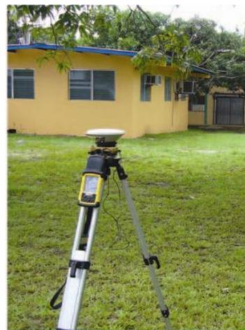
Parte del equipo utilizado para el levantamiento topográfico.
